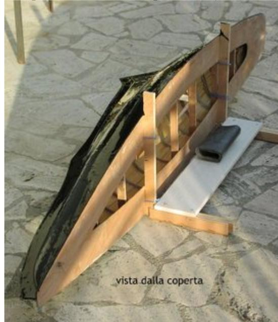
Tre strati di gelcoat sono stati dati nella stessa giornata (temperatura di 19/22°) con un intervallo di 2h1/2 circa, la prossima operazione sarà la laminazione di due strati in tessuto di vetro da 160g/m<sup>2</sup>/epoxy, seguirà una copertura con diversi strati di mat di vetro per inrobustire la forma dello stampo
