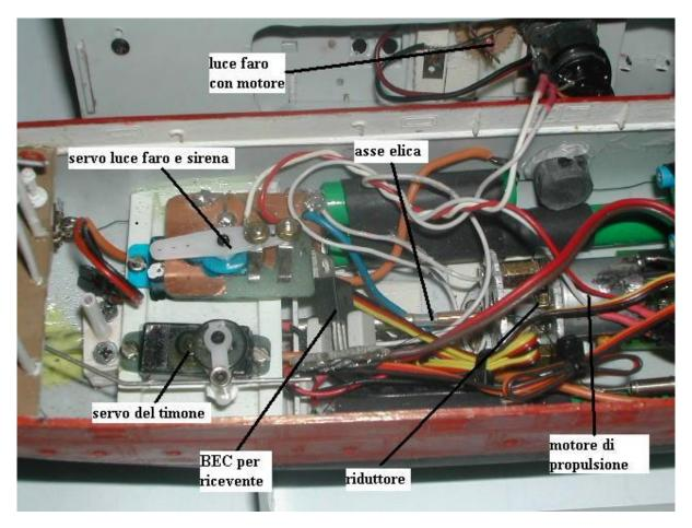
Il motore è alimentato a 7,2 V (sei elementi Ni M Hi) mentre la ricevente a 4,8, per questo è stato necessario istallare un BEC che riduce la tensione da 7,2 a 4,8. Il circuitino è semplicemente l'integrato LV 7005 con due condensatori in parallelo tra la le tensioni e massa, sia in ingresso che in uscita.
