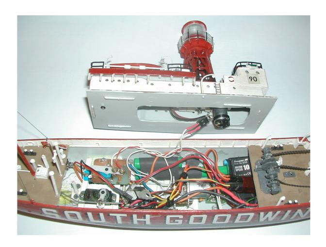
Il motore di propulsione è stato ricavato da un servo in cui la parte di regolazione si era danneggiata ed il ruttore di giri è ricavato utilizzando il primo ingranaggio della riduzione del servo. Il modello è provvisto di una sirena elettronica con altoparlantino acquistati da Conrad e della luce girevole. I due meccanismi sono controllati da un servo sulla cui leva sono istallate due lamelle che chiudono i due circuiti su due piste ricavate da una piastra per circuiti stampati.
